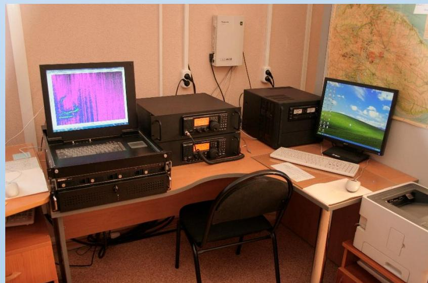
**В Ловозеро проводятся регулярные наблюдения методом непрерывной цифровой регистрации вариаций магнитного поля Земли с помощью магнито-вариационного комплекса. Регистрирующая аппаратура установленная в магнитном павильоне, работает автоматически, постоянно и непрерывно.**
