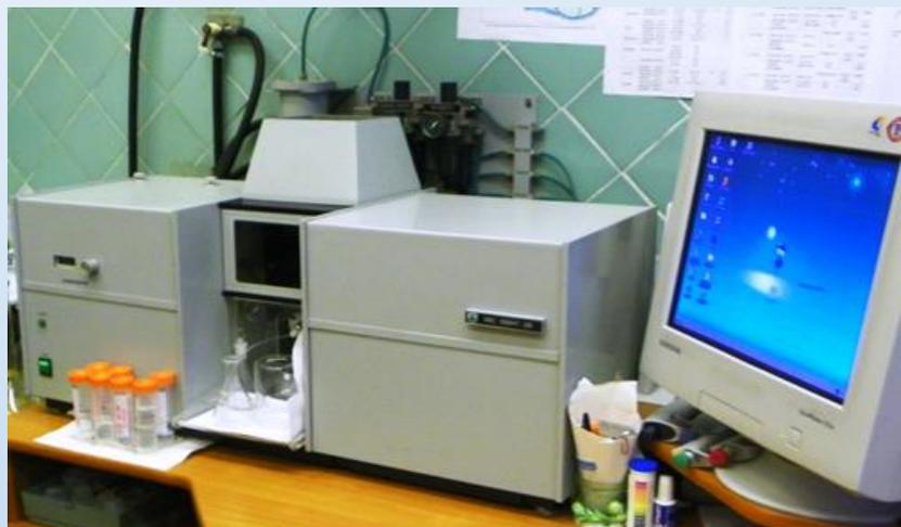
Выполнение измерений в пробах атмосферного воздуха тяжелых металлов методом атомно-абсорбционной спектроскопии.
