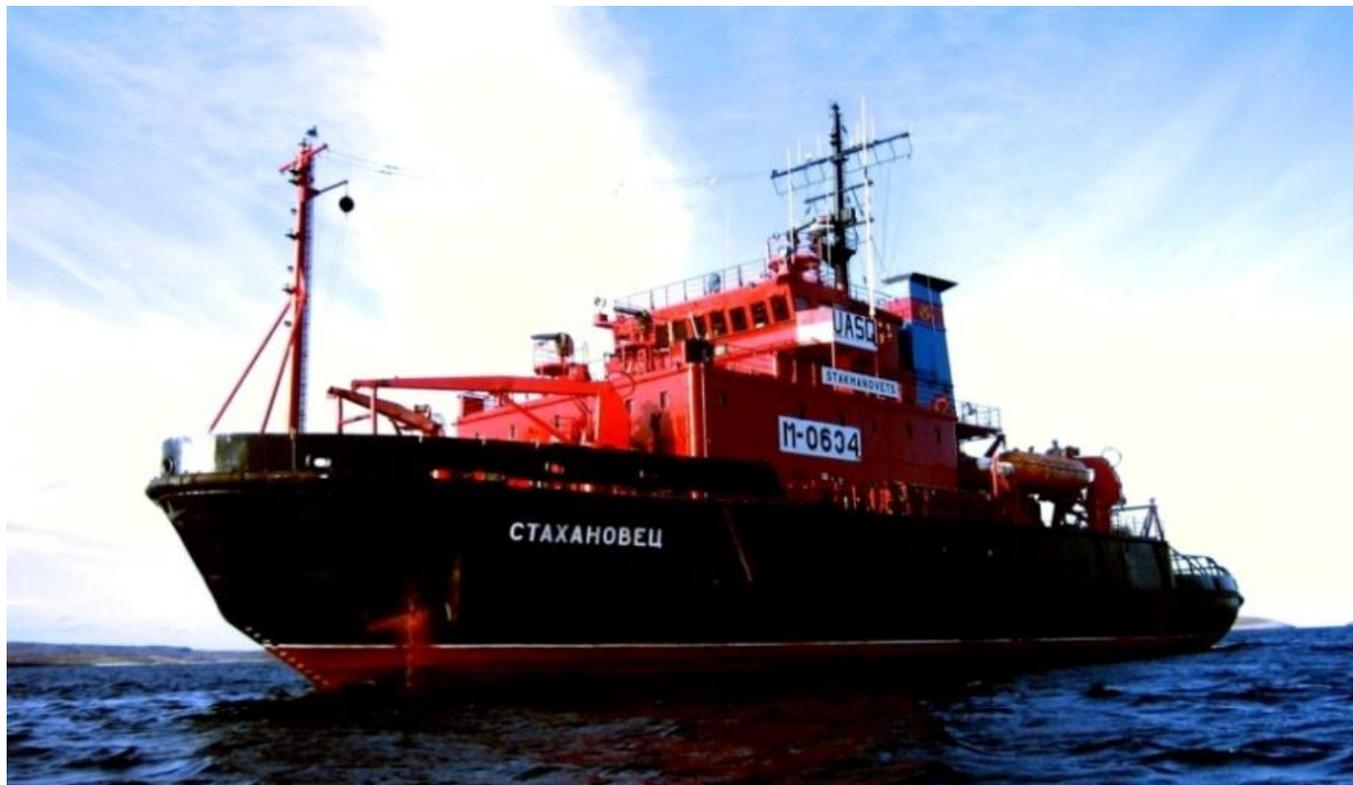
ЛСС Стахановец - ледокольное – спасательное судно, основное предназначение оказание помощи судам, терпящим бедствие в море, снятие с мели, тушение пожара, подводная сварка и резка, поисковые и эвакуационные работы, выполнение морских буксировок судов и плавучих сооружений, оказание первой медицинской помощи силами судового врача и лазарета, ледовые проводки судов.
