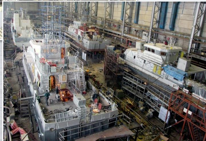
За счёт серийного строительства судов отработаны и оптимизированы все сборочные процессы судна: от прецензионной сборки корпусов до калибровки сложнейшего оборудования на кораблях и судах. Основной сборочный эллинг отапливаемый, это позволяет вести монтажные работы на высоком уровне круглый год.
